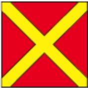
Un panneau carré rouge horizontal à diagonales jaunes indique, lorsqu'il est disposé sur l'aire à signaux, que les atterrissages sont interdits et que l'interdiction peut se prolonger.
