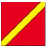
Un panneau carré rouge horizontal avec une seule diagonale jaune indique, lorsqu'il est disposé sur l'aire à signaux, qu'en raison du mauvais état de l'aire de manoeuvre ou pour toute autre raison, des précautions spéciales doivent être prises au cours de l'approche ou au cours de l'atterrissage.
