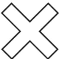
Des croix d'une couleur uniforme contrastante, jaune ou blanche, disposées horizontalement sur des pistes ou des voies de circulation ou sur des parties de piste ou de voie de circulation indiquent des zones impropres aux manoeuvres des aéronefs.
